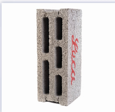
بلوک ۱۵ (سه جداره) ابعاد: ۴۹ * ۲۰ * ۱۴٫۵ وزن: ۱۰/۷ کیلوگرم ضخامت جداره: ۳ سانتی متر
