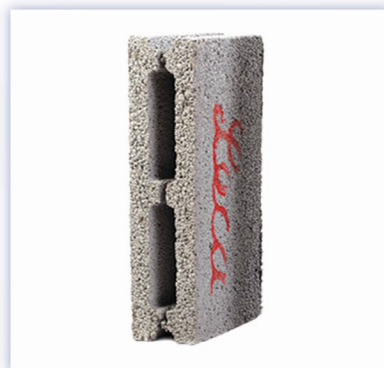
بلوک ۱۰ (دو جداره) ابعاد: ۴۰ * ۲۰ * ۱۰ وزن: ۵/۸ کیلوگرم ضخامت جداره: ۳ سانتی متر
